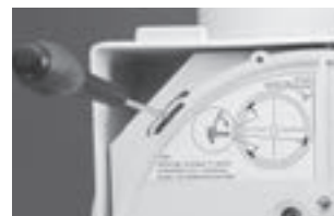
Démontage de la plaque-moteur
